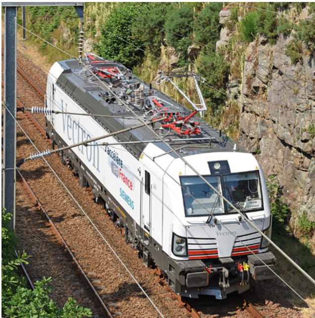
Abbildung 2 – Mehrsystemlokomotive, bei der bereits durch die Hochspannungsanlage die ganze Dachfläche ausgeschöpft ist
