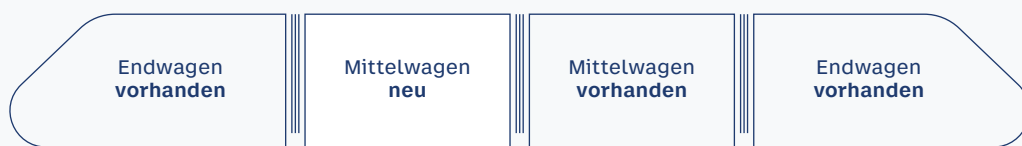
Abbildung 23: Retrofit: Neuer Mittelwagen wird in Triebzug eingefügt
